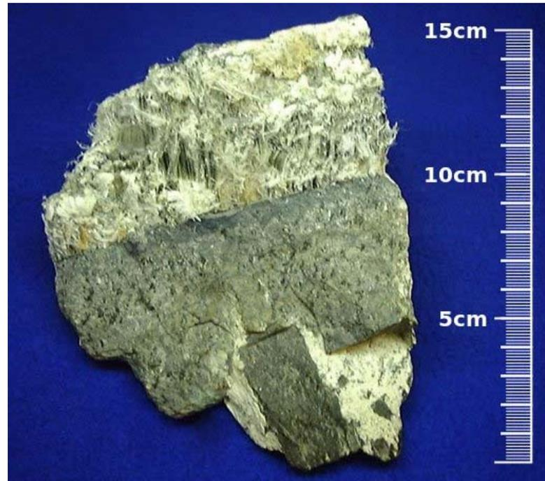
Questi minerali silicatici hanno la proprietà di separarsi in fibre estremamente sottili (di diametro anche inferiore a 20-30 nm), le **fibre asbestiformi**. Esistono circa 30 varietà di minerali che hanno questa caratteristica, ma solo 6 di queste hanno avuto importanza tecnologica e commerciale.
