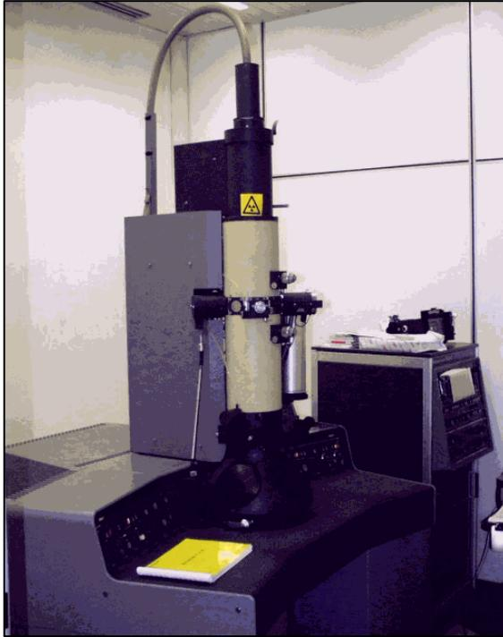
Riconosce le fibre senza ambiguità e distingue fibre con diametro di  $0,0025 \mu\text{m}$ .
